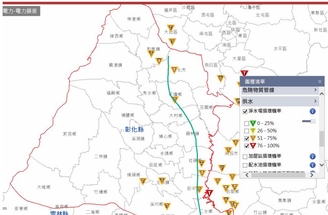
圖1-3-9模擬淨水廠損壞機率
