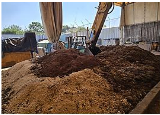
圖 5：廚餘處理後整批拌乾料作成養豬肥料
