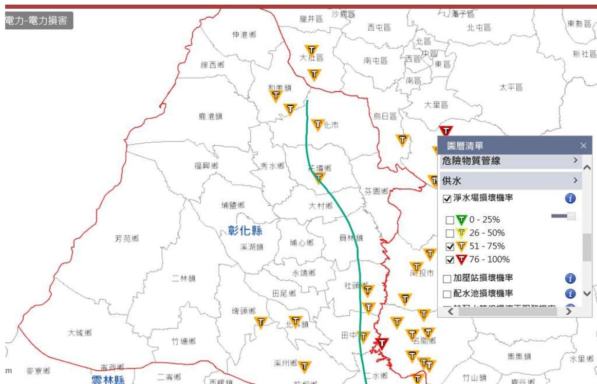
圖 1-3-10 模擬淨水廠損壞機率
