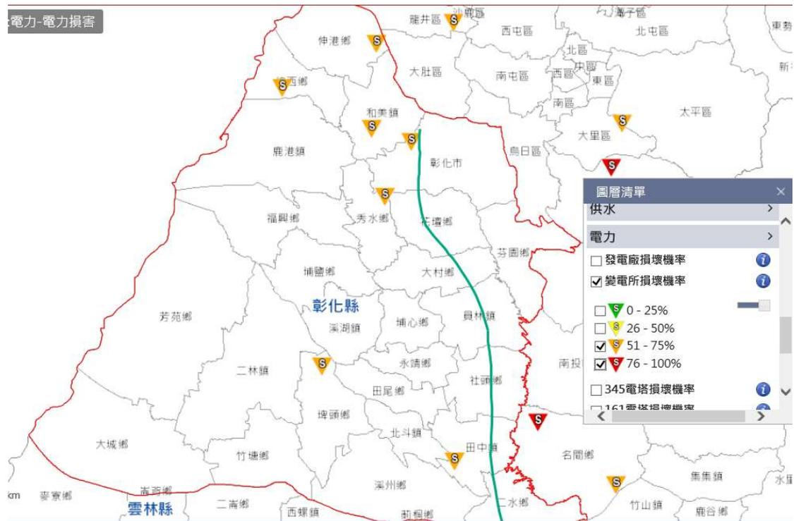
圖 1-3-9 模擬變電所損壞機率
