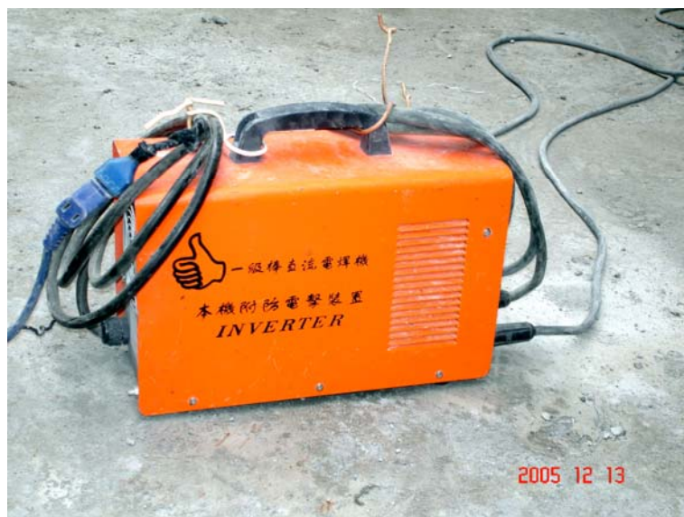
電銲機接頭於負載側的裸線範圍，套入塑膠活動管被覆 (內建自動電擊防止裝置)
