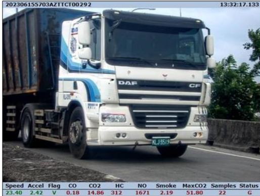
圖 32：光學遙測監測污染物濃度
